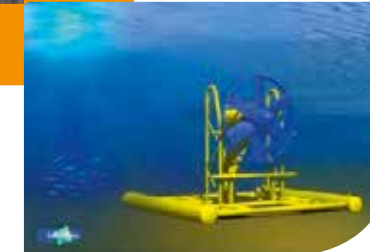
Représentation d'une hydrolienne SABELLA D10
